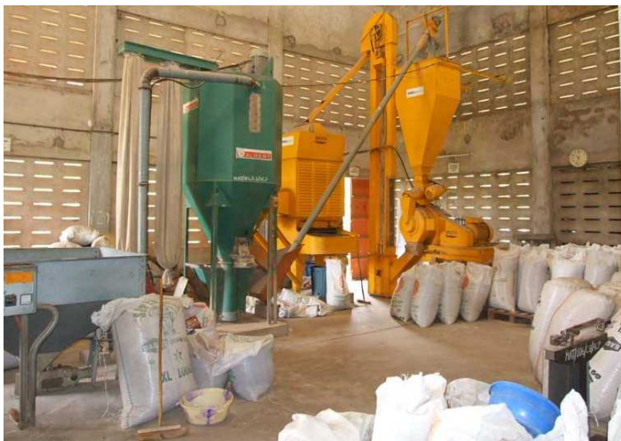
Il faut disposer d'un bon broyeur-mélangeur et s'assurer de l'approvisionnement régulier en matières premières, avant de s'engager dans la provenderie
