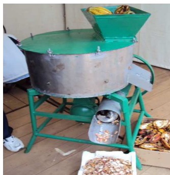
L'écabosseuse de cacao fabriquée par un Camerounais
